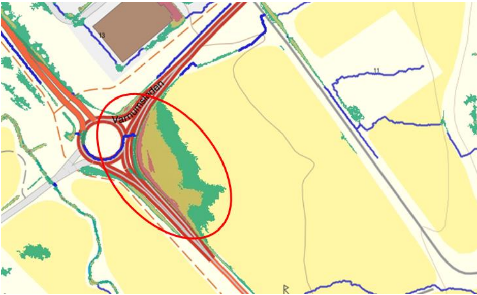
Figur 9. Översvämningsutbredning i anslutning till cirkulationsplats vid väg 26. Regementsområdet ligger nordöst, utanför figurens utsträckning. Röda fält visar vattendjup > 50 cm, gula 20 – 50 cm och gröna < 20 cm. Källa: SCALGO Live
