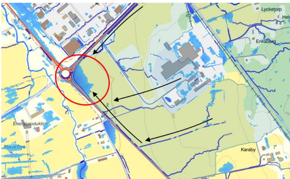
Figur 8. Riskområde nedströms utredningsområdet i avrinningsområde 5. Vattnet avrinner till en lågpunkt vid cirkulationsplatsen vid väg 26. Källa: SCALGO Live
