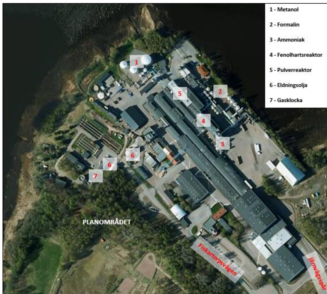
Figur 6.1. Redovisade riskkällor som enligt tabell 6.1 behöver tas hänsyn till vid exploatering inom planområdet.
