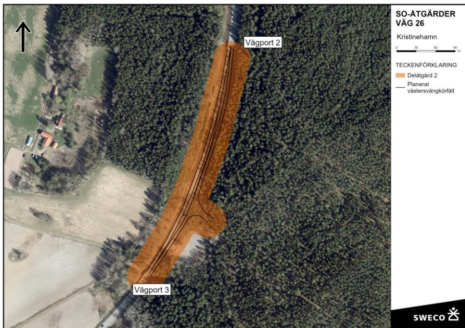
Figur 3-5. Lokalisering av Delåtgärd 2 samt planerad C-korsning med vänstersvängkörfält (Ortofoto: Lantmäteriet, geodatasamverkan. Vänstersvängkörfält: ritning 02, Sweco, 2023c).
