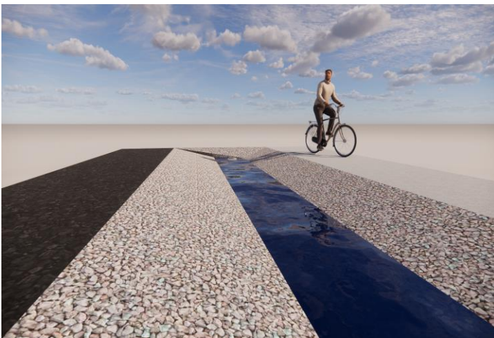
Figur 6-5. Vägdikey med makadambotten (Illustration: Sweco).
