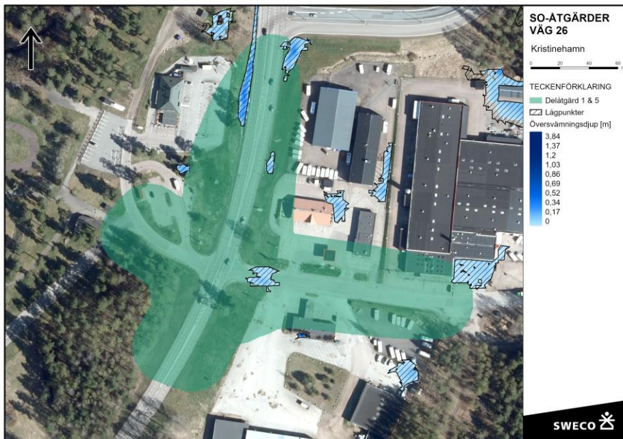
Figur 3-12. Befintliga lågpunkter där det finns risk för översvämning inom Delåtgård 1 & 5 (Data: Scalgo Live. Ortofoto: Lantmäteriet, geodatasamverkan).
