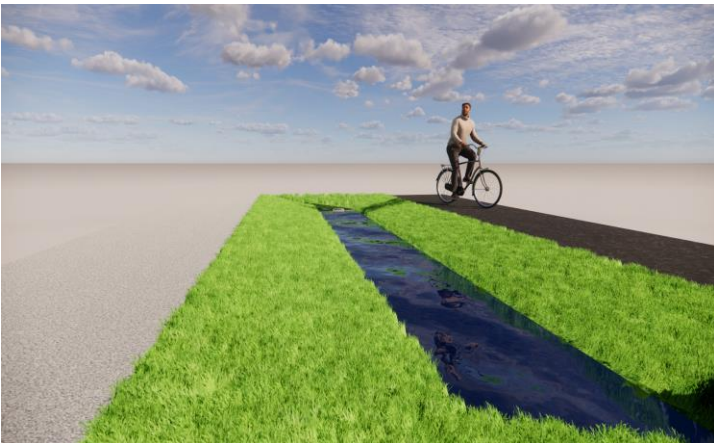
Figur 6-7. Grönt vägdike (Illustration: Sweco).
