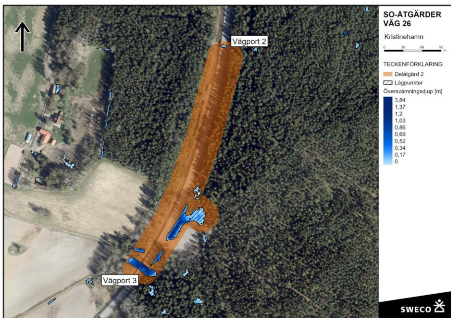
Figur 3-14. Befintliga lågpunkter där det finns risk för översvämning inom Delåtgård 2 (Data: Scalgo Live. Ortofoto: Lantmäteriet, geodatasamverkan).
