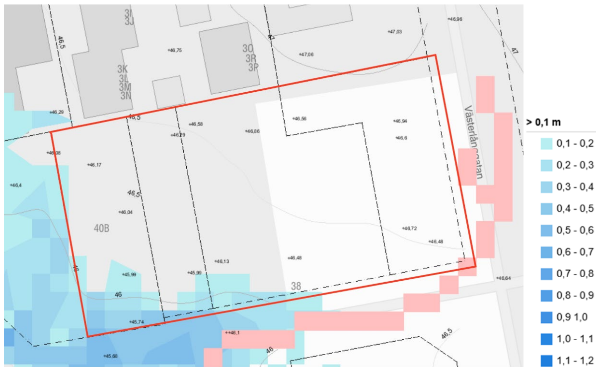
Karta: Planområdet i rött. Redovisat är markhöjder, Vänernivå +46.20 (RH2000) och flödesväg i ljusrött.
