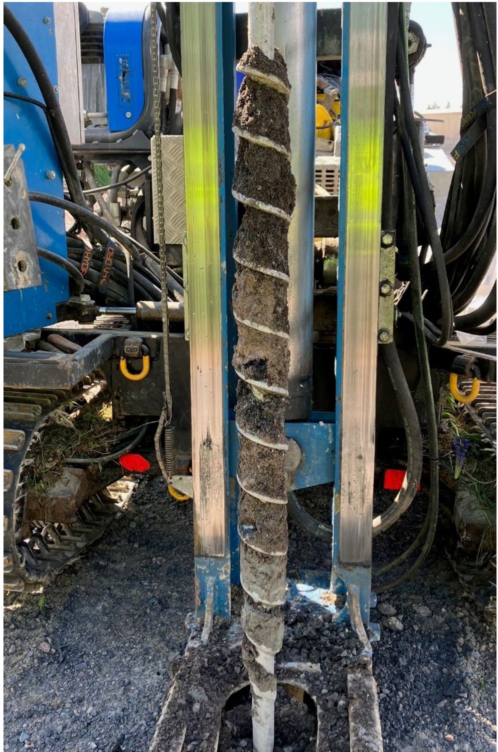
Figur 15. Foto taget 2023-06-02. Fyllning mellan 0–1,0 m i provpunkt 23M302.
