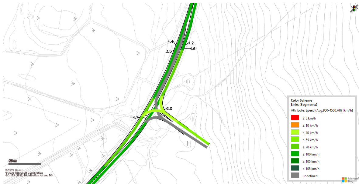
Figur 115 Vissim-test (Heatmap) för projektprognos (steg 5) för alternativ 2B-D under förmiddagens maxtimme trafik
