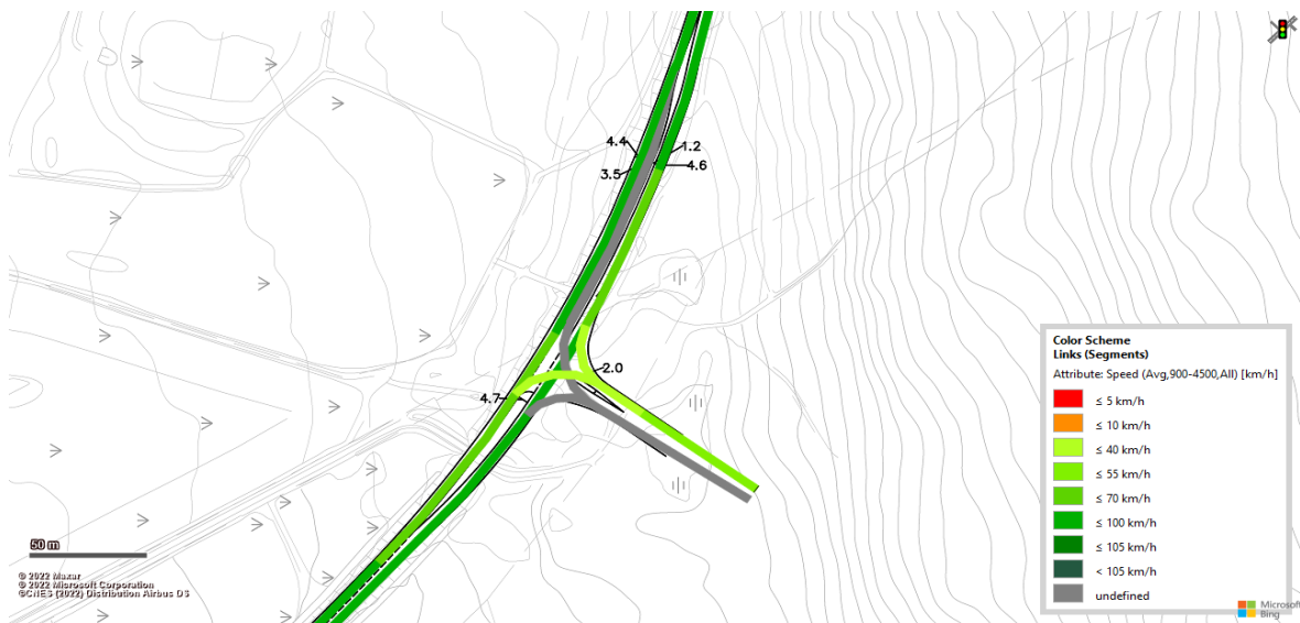
Figur 113 Vissim-test (Heatmap) för projektprognos (steg 4) för alternativen 2B-D under eftermiddagens maxtimme trafik
