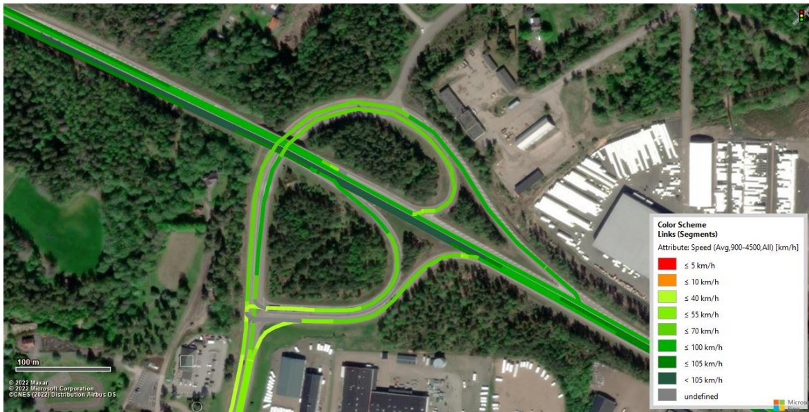
Figur 144 Vissim-test (Heatmap) för känslighetsprognos (steg 5) för Alternativ 4A för Kvarnmotet under förmiddagens maxtimme
