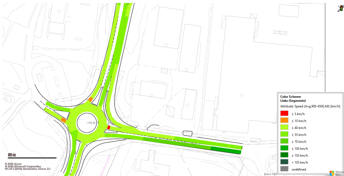
Figur 86 Vissim-test (Heatmap) för känslighetsprognos (steg 5) för Alternativ 1C och 1D för den norra infarten under eftermiddagens maxtimme
