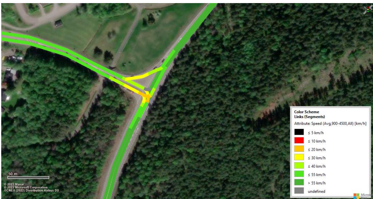
Figur 132 Vissim-test (Heatmap) för projektprognosen (Steg 4) för Närkevägen med eftermiddagens maxtimme trafik, givet oförändrad befintlig infrastruktur på väg 26 i hela området.
