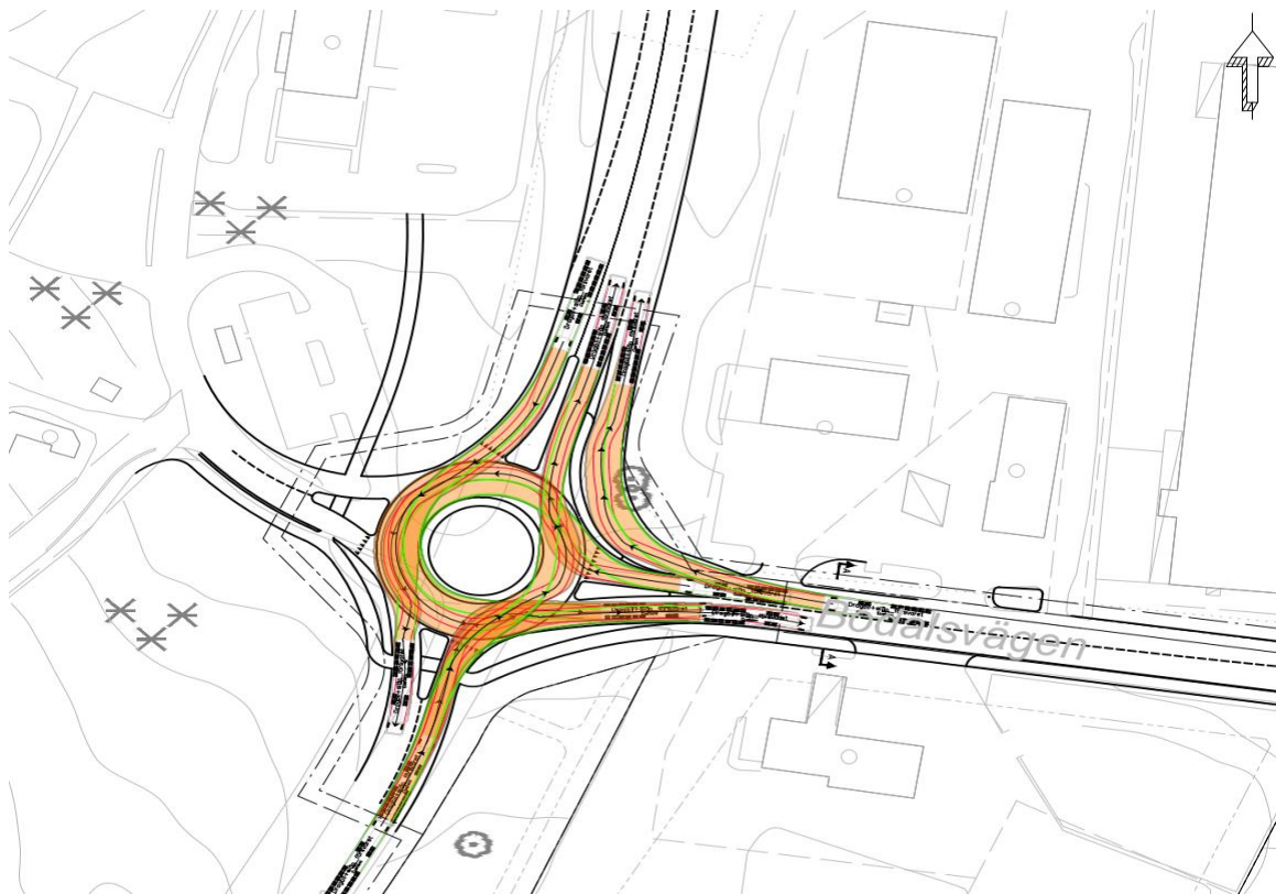
Figur 76 Körspårskontroll för tungdragare med släp i Alternativ 1B, 1C och 1D enfältig cirkulation med högersvängfält
