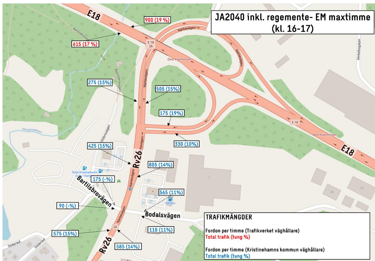
Figur 44. Trafikmängd för projektprognosen (steg 4) under eftermiddagens maxtime.
