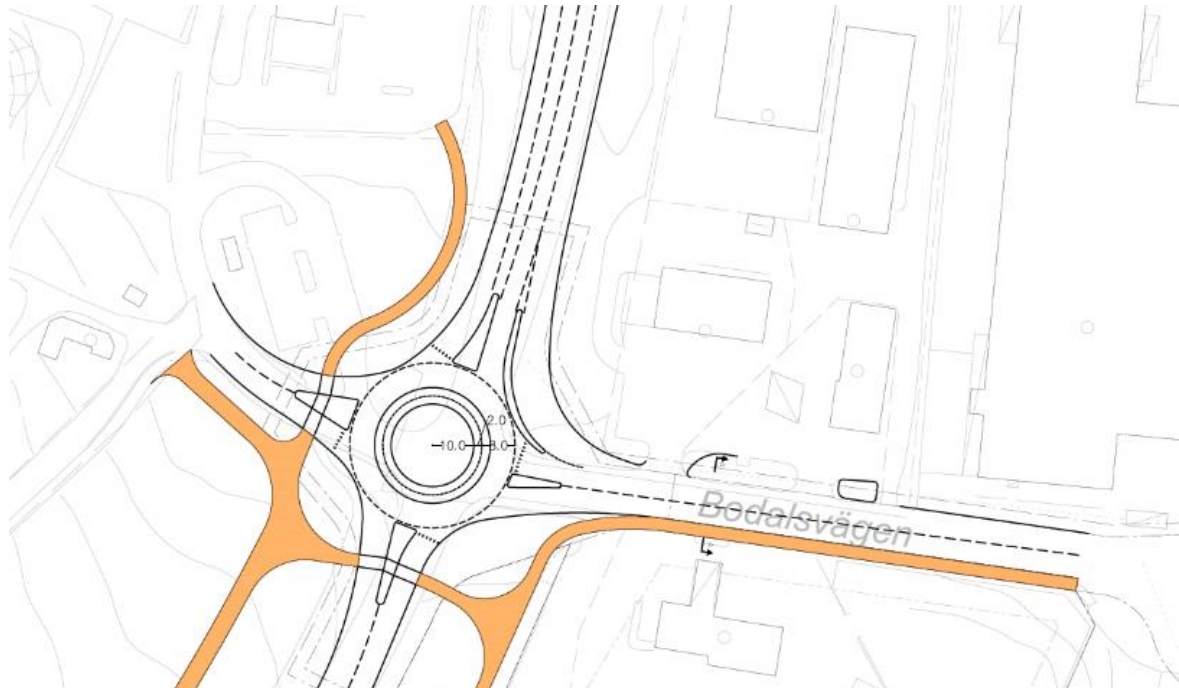
Figur 168 Alternativ 1D– Norra infarten som enkelfilig cirkulationsplats med passage för cykel i söder och väster och med extra höger-ut svängfält från öster mot norr samt dubbelfilighet norrut
