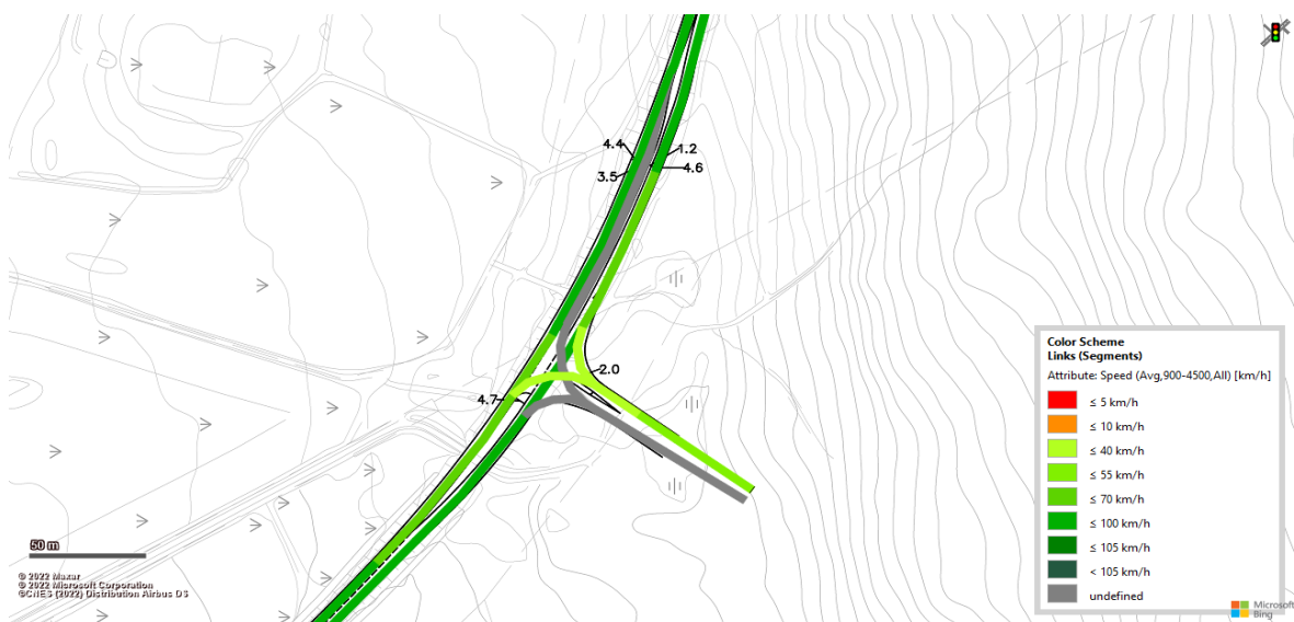
Figur 123 Vissim-test (Heatmap) för projektprognos (steg 4) för alternativ 2B-D under eftermiddagens maxtimstrafik
