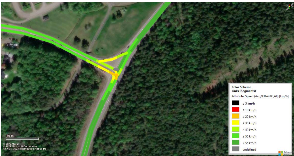
Figur 134 Vissim-test (Heatmap) för projektprognosen (Steg 4) för Närkevägen med eftermiddagens maxtimme trafik, givet en trevägskorsning i söder som infart till Harberget samt att norra infarten byggts om till en cirkulationsplats (1A-1D)..
