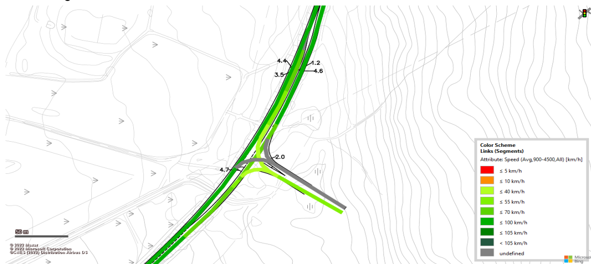
Figur 121 Vissim-test (Heatmap) för projektprognos (steg 4) för alternativen 2B-D under förmiddagens maxtimme trafik
