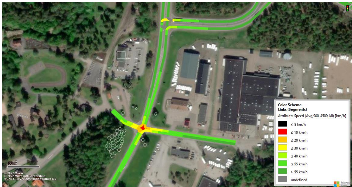
Figur 15. Vissim-test (Heatmap) för nulägestrafik under eftermiddagens maxtimme.
