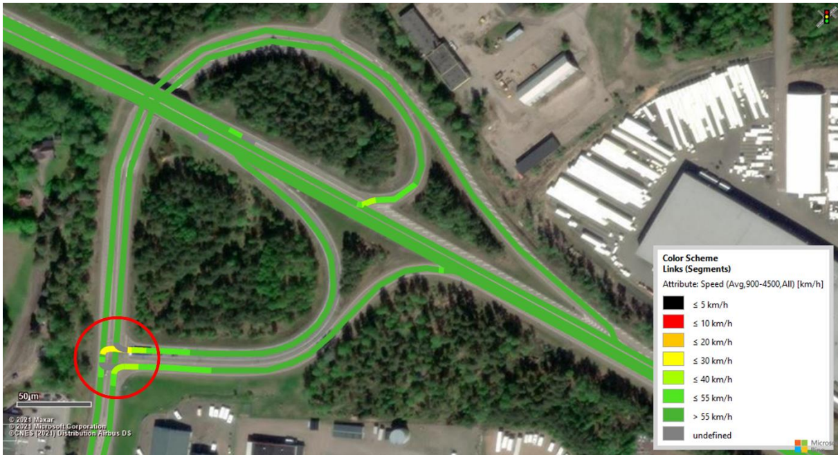
Figur 19. Vissim-test (Heatmap) för Övre Kvarmotet - Nulägestrafik under eftermiddagens maxtimme.
