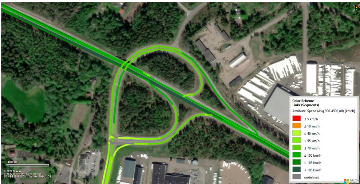
Figur 143 Vissim-test (Heatmap) för känslighetsprognos (steg 5) för Alternativ 4A för Kvarnmotet under eftermiddagens maxtimme
