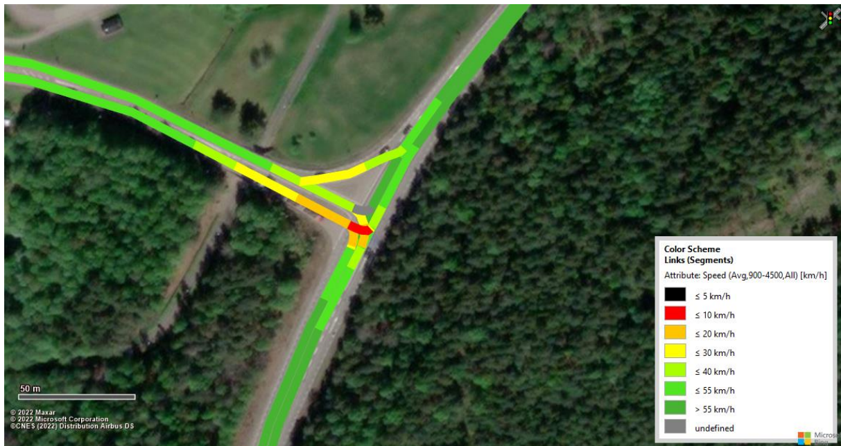
Figur 49. Vissim-test (Heatmap) för projektprognosen STEG 4 Närkevägen med eftermiddagens maxtimmestrafik, befintlig infrastruktur.
