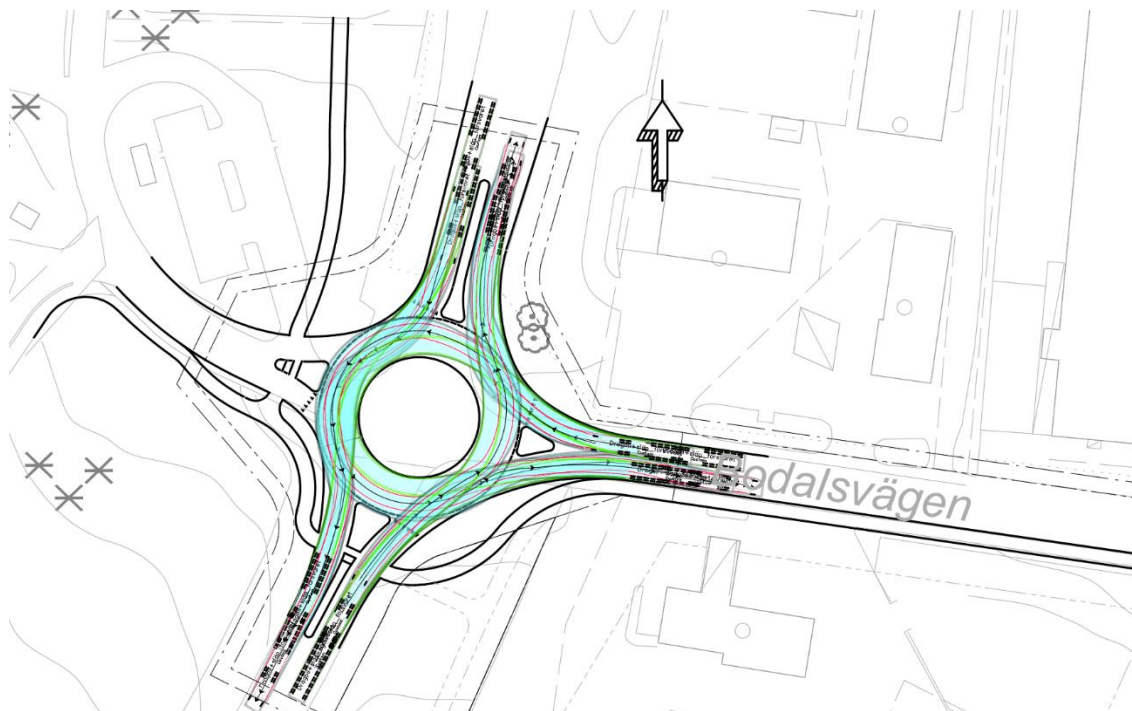
Figur 67 Körspårsanalys för tungdragare med släp i alternativ 1A
