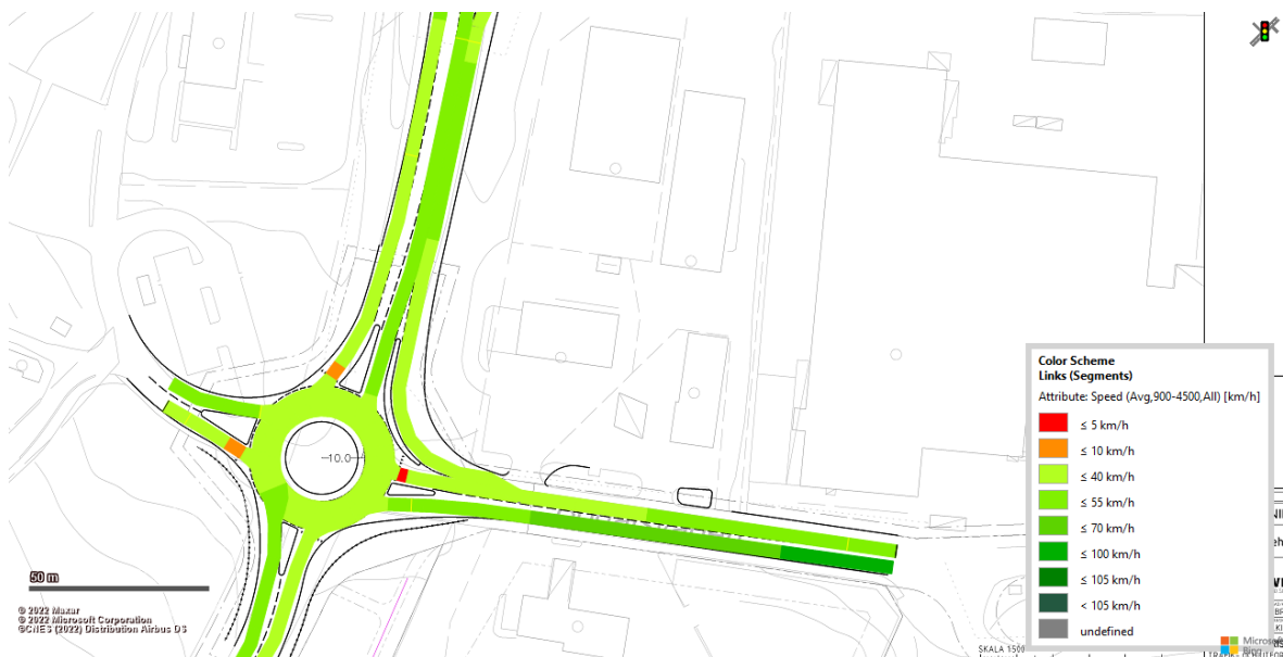
Figur 91 Vissim-test (Heatmap) för känslighetsprognos (steg 5) för Alternativ 1C och 1D för den norra infarten under eftermiddagens maxtimme
