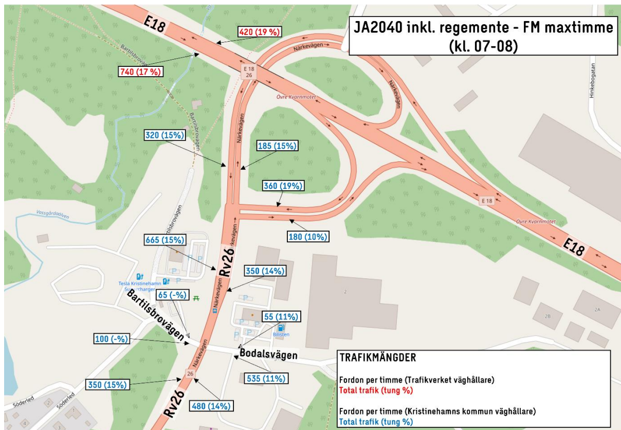
Figur 43. Trafikmängd för projektprognosen (steg 4) under förmiddagens maxtime.
