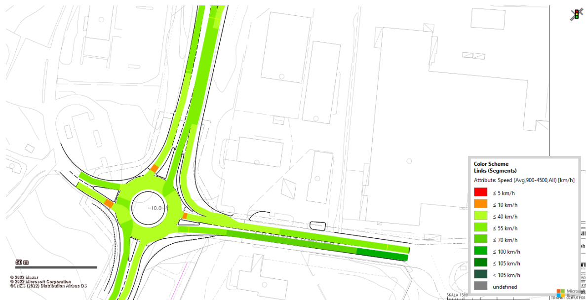
Figur 90 Vissim-test (Heatmap) för projektprognos (steg 4) för Alternativ 1C och 1D för den norra infarten under eftermiddagens maxtimme
