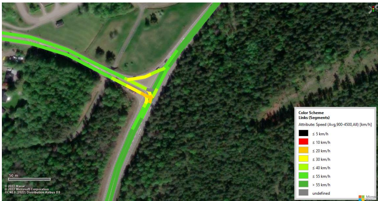
Figur 48. Vissim-test (Heatmap) för projektprognosen STEG 4 vid Närkevägen med förmiddagens, befintlig infrastruktur
