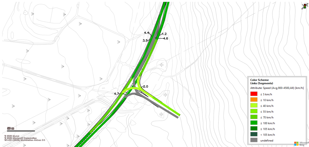
Figur 103 Vissim-test (Heatmap) för projektprognos (steg 4) för alternativ 2B-D under eftermiddagens maxtimme trafik
