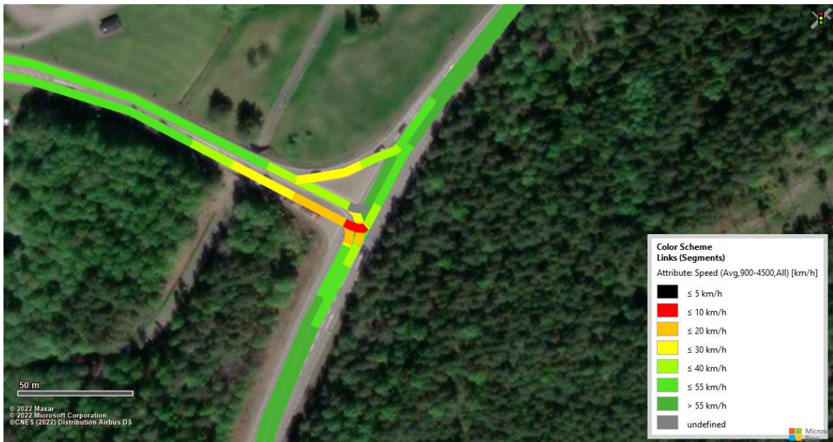
Figur 133 Vissim-test (Heatmap) för projektprognosen (Steg 4) för Närkevägen med förmiddagens maxtimme trafik, givet en trevägskorsning i söder som infart till Harberget samt att norra infarten byggts om till en cirkulationsplats (1A-1D).
