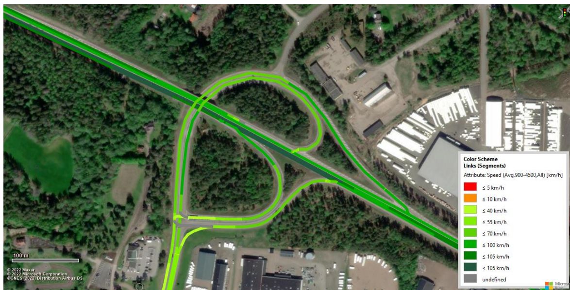
Figur 142 Vissim-test (Heatmap) för projektprognos (steg 4) för Alternativ 4A för Kvarnmotet under förmiddagens maxtimme
