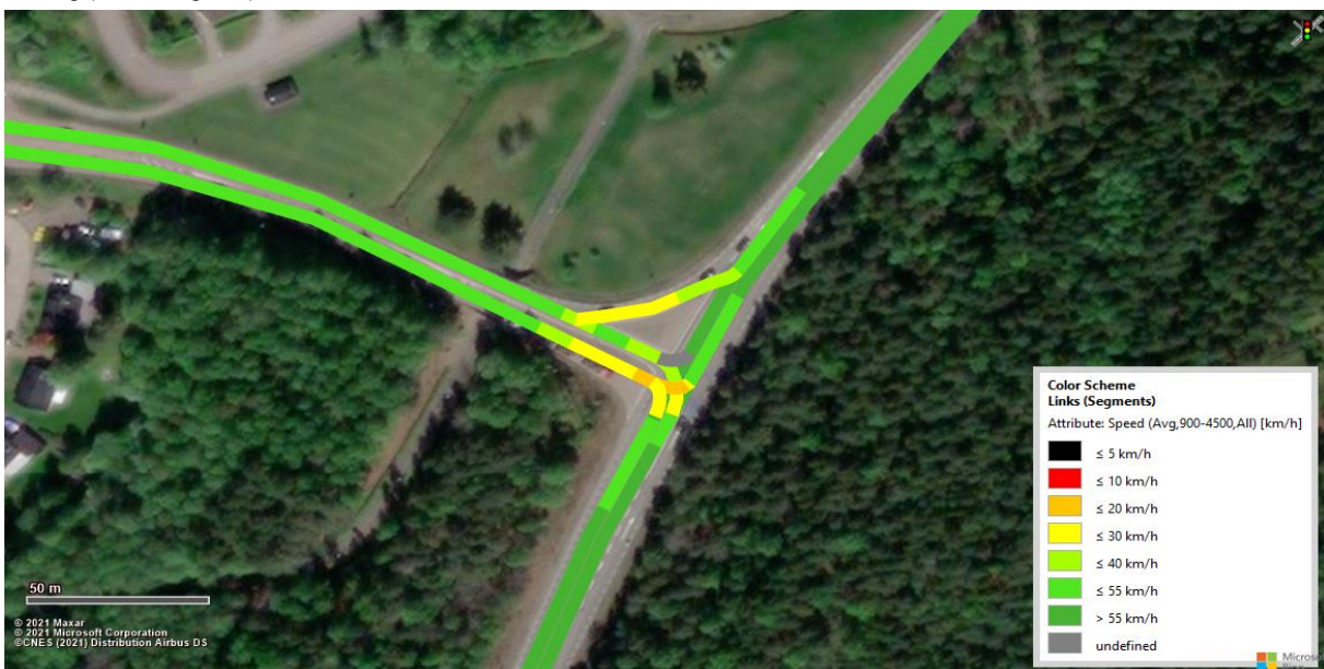
Figur 23. Vissim-test (Heatmap) för Närkevägen - Nulägestrafik under eftermiddagens maxtimme.
