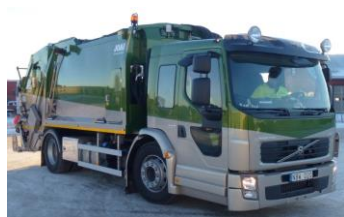
Bild 3 Komprimerande baklastad sopbil
